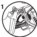
Pistola travada (a pistola não pulverizará)
