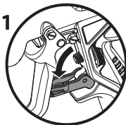
Gatilho bloqueado (a pistola não pulveriza)
